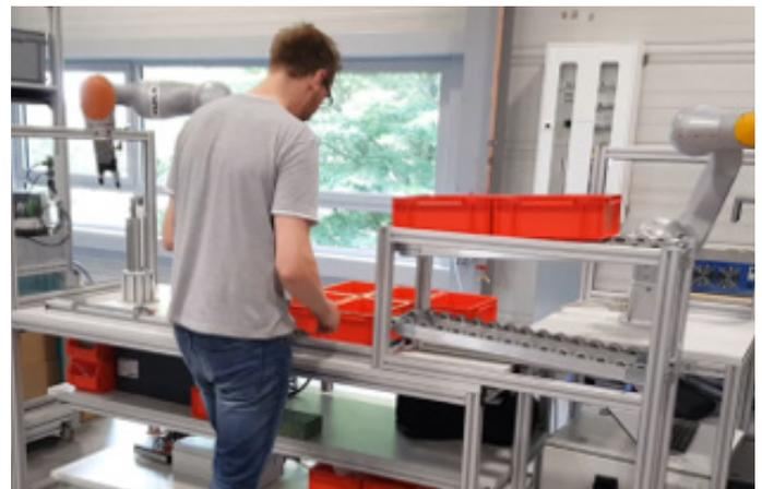
Foto: Unterstützung in der Klemmleistenmontage durch Robotertechnologie.
